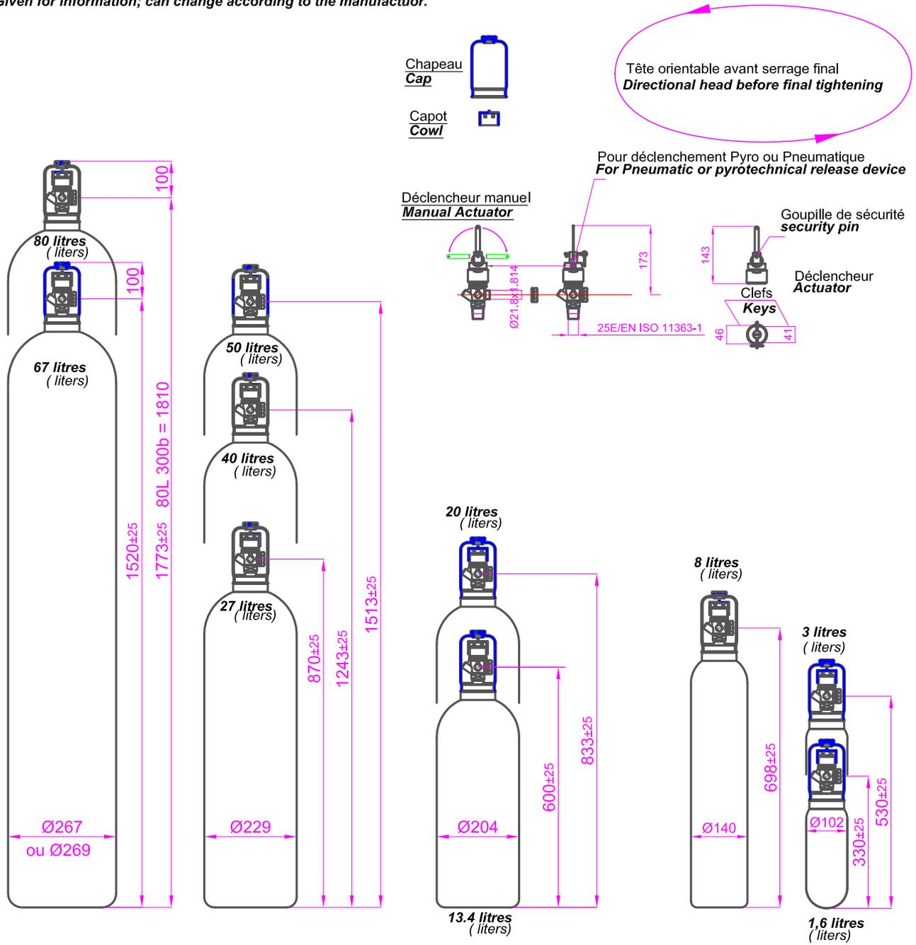
Bouteille livrée avec chapeau de transport, capot et bouchon de sécurité vanne.
